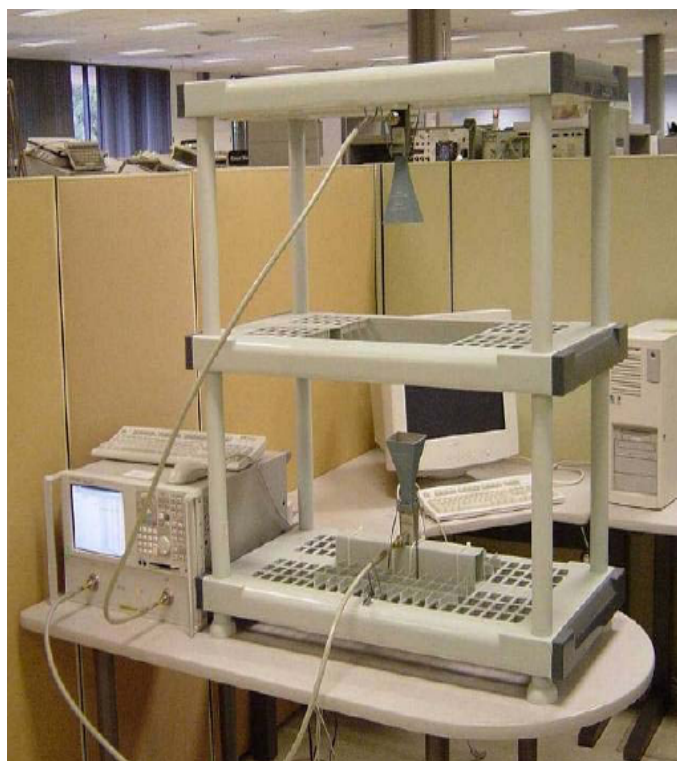
Figura 13: Setup de medición en banda X
